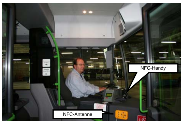
Abbildung 3: Die eingebaute NFC-Antenne
