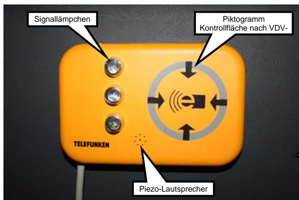
Abbildung 4: Die NFC-Antenne im Detail
