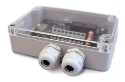
Um die IBIS Informationen an Endgeräte zu senden, wird Bluetooth Smart Technologie eingesetzt. Dieser Standard wird im Gegensatz zu RFID (Radio-Frequency Identification) bereits von vielen handelsüblichen Smartphones unterstützt und zeichnet sich gleichzeitig durch einen geringen Stromverbrauch aus. Durch die Bluetooth Advertising-Funktion werden die Informationen in die nähere Umgebung des Busses (ca. 30-50 Meter) gesendet und können ohne Bluetooth-Koppelung der Geräte empfangen werden
