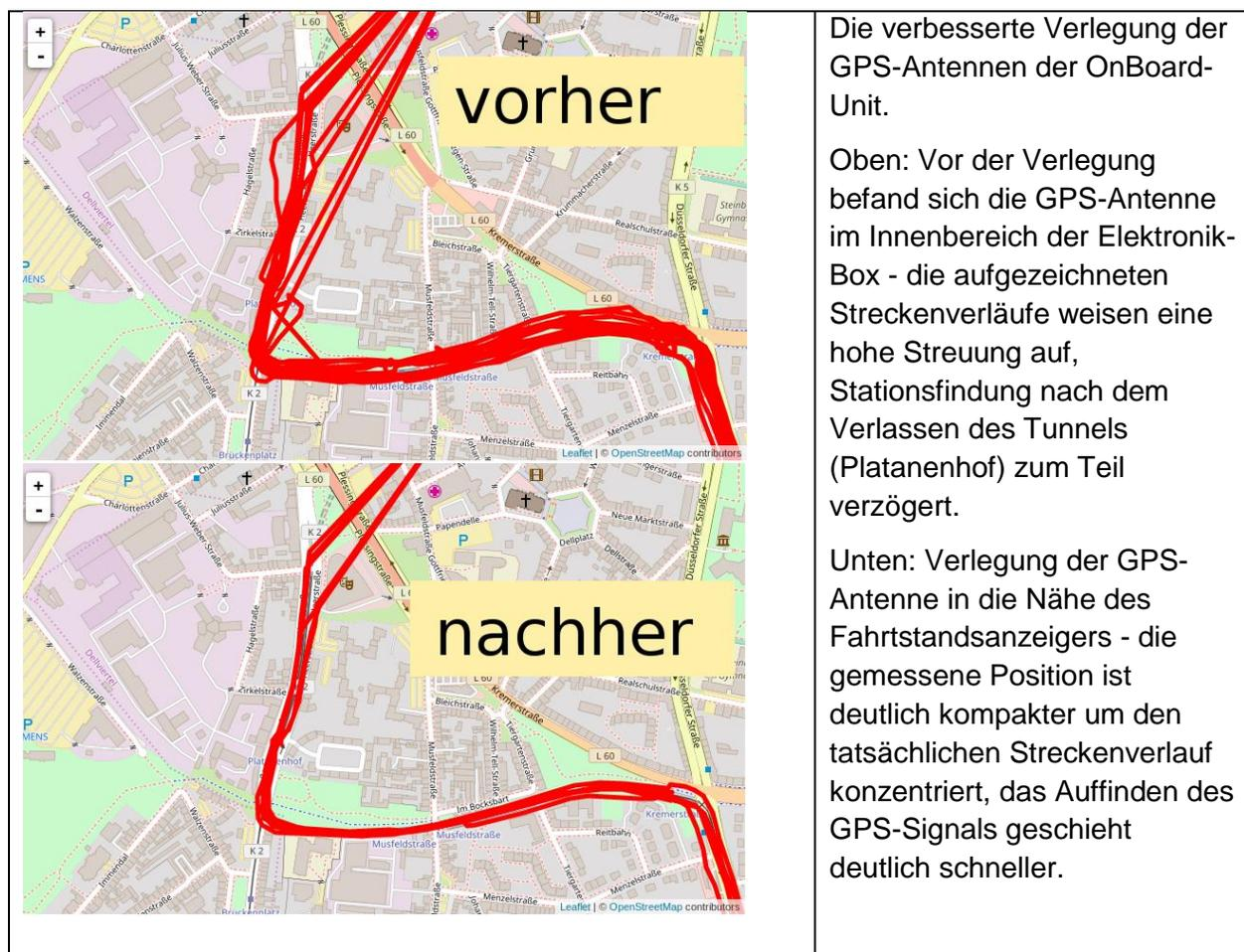
Abbildung 11: Positionsgenauigkeit vor und nach Verlegung der GPS-Antenne
